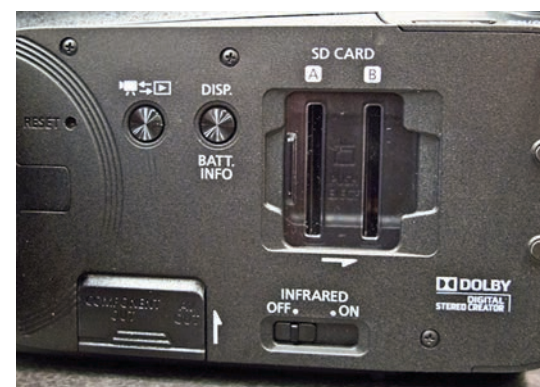
Sur le côté du XA10, l'emplacement pour deux cartes d'enregistrement et le bouton de mise en service pour la prise de vue en infrarouge
